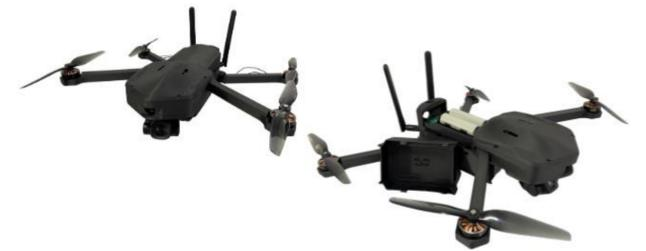
Figura 5. Gemini 2 fabricado en impresión 3D.
